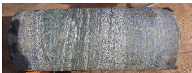
Photo 1 : Magnetite-quartz-garnet-chlorite Gneiss (Drillhole NESD011)
